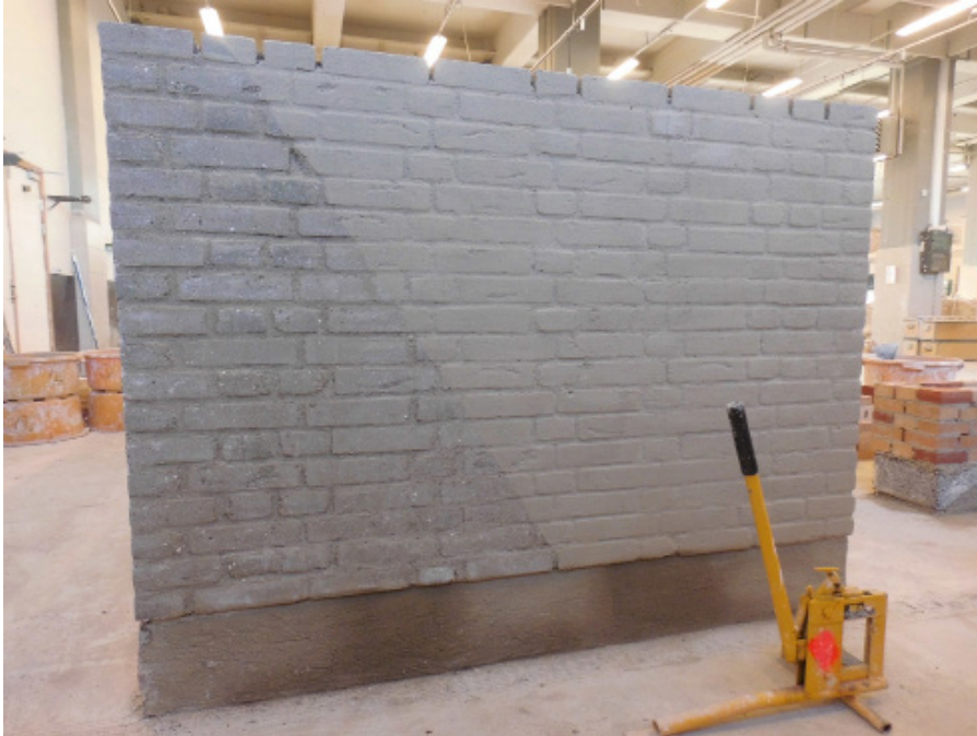
Væg på murergrundforløb udført med ubrændte lersten.
